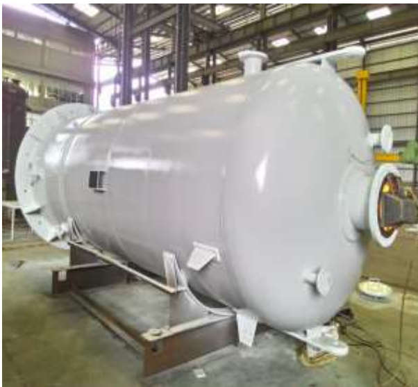
Gambar 13. Permukaan vessel setelah di cat akhir
